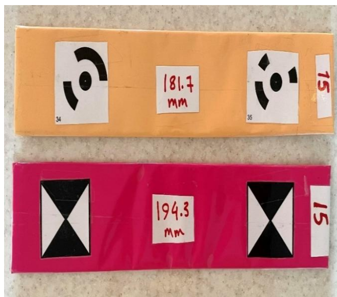
شکل ۴- شمایی نزدیک از طول تارگت و طول چک‌های نصب‌شده بر روی تنه درختان
