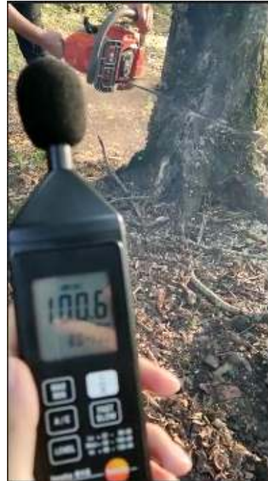
شکل ۱- اندازه‌گیری صدای ناشی از اره‌موتوری
