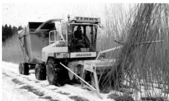
شکل ۱- چاپر مخصوص برداشت صنوبر در روش بهره‌برداری کوتاه مدت
