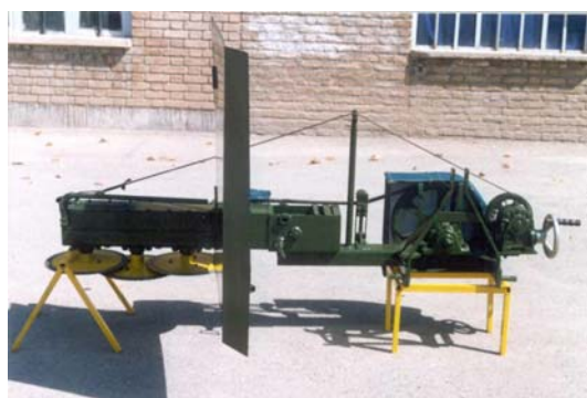
شکل ۱۰- ماشین برداشت تراکتوری صنوبر
