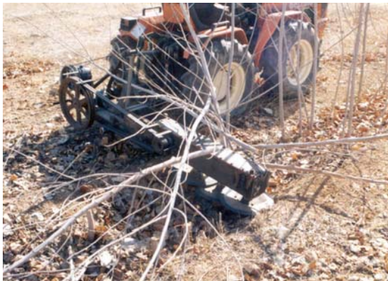
شکل ۷- ماشین برداشت صنوبر در حال انجام ارزیابی اولیه
