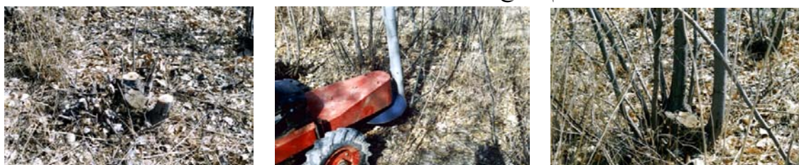
شکل ۱۱- قطع نهال به وسیله علف‌بر موتوری با ااره‌گرد
