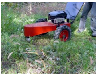
شکل ۸- مبارزه با علفهای هرز با تیغه نخ نایلونی
