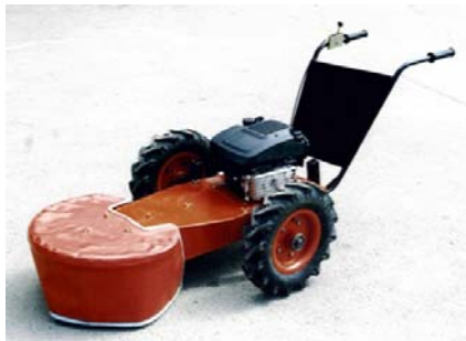
شکل ۵- دستگاه علف بر موتوری پس از ساخت
