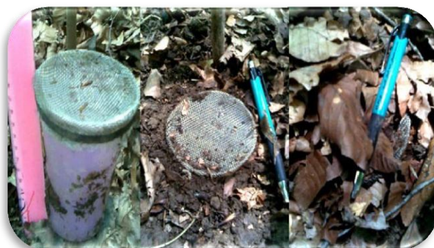
شکل ۱- ظرف‌های جمع‌آوری‌کننده آب نفوذی به لاشریزه
