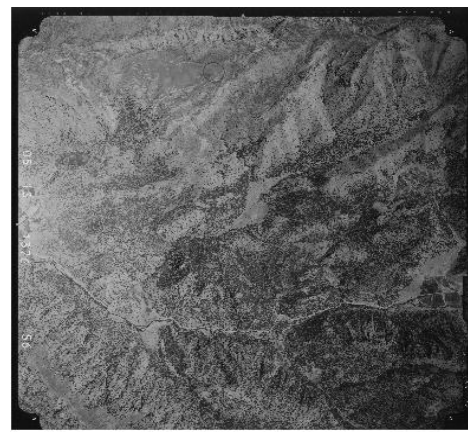
شکل ۵- عکس هوایی تصحیح نشده
